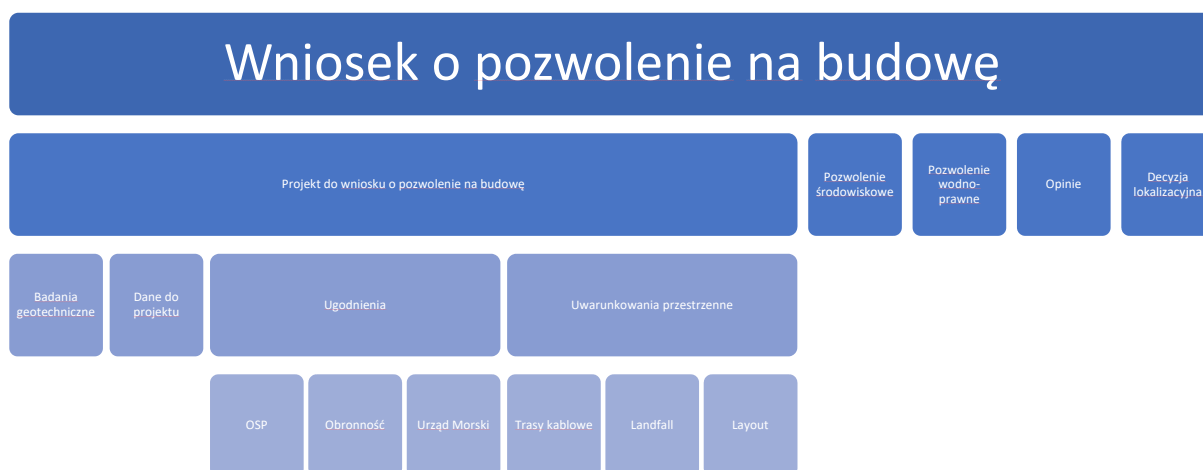
Rysunek 11. Schemat niezbędnych dokumentów, pozwoleń i uzgodnień dla wniosku pozwolenia na budowę
